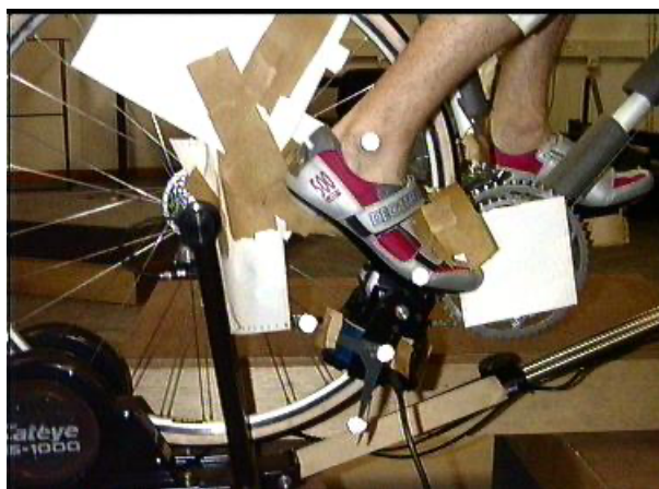
Figure 17 : pédales instrumentées droite et gauche du vélo avec 2 cellules de force tridimensionnelles LOGABEX
