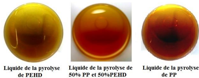
Figure 3. 69 : Exemples de liquides pyrolytiques produits par pyrolyse de mélange équi-massique PEHD-PP
