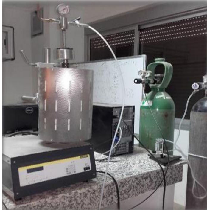
Figure 3. 45 : Dispositif expérimental de la pyrolyse sous pression.
