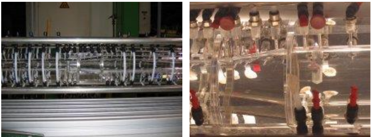
Figure 1.0.7. a) Photos de la veine d'essais, b) zoom sur la singularité (divergent progressif)
