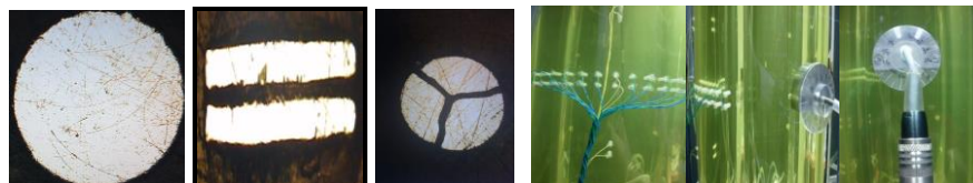
Figure. 1.0.19. Microphotographies et photos des sondes électrochimiques simples, doubles et triples utilisées
