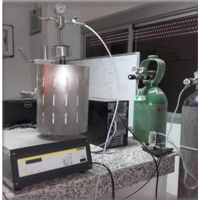
Figure 3. 45 : Dispositif expérimental de la pyrolyse sous pression.
